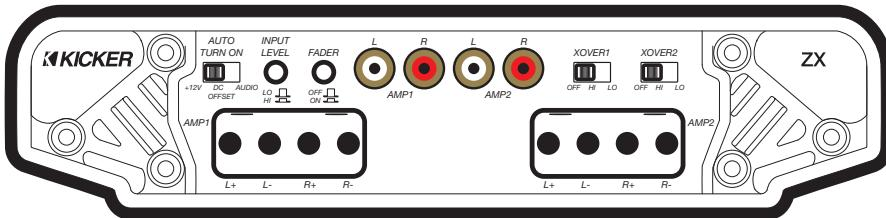
**Selección de Encendido Automático:** La serie ZXM ofrece tres modalidades de encendido automático que se pueden seleccionar en el panel de extremo: +12V, compensación de CC y audio. Las modalidades de audio o compensación de CC dan +12V a la terminal REM para encender otros amplificadores.
